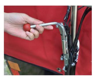
Hebel hochziehen und runterlassen. Dadurch senkt sich unter dem Transportrad eine Stütze ab.
