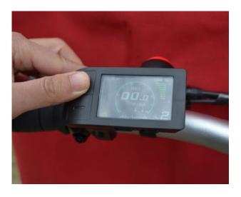
E-Antrieb auf Display aktivieren. Dafür an der **Unterseite** den **An/Aus-Knopf** drücken! Den Antrieb über das **Plus-** und **Minus-Zeichen** verändern.
