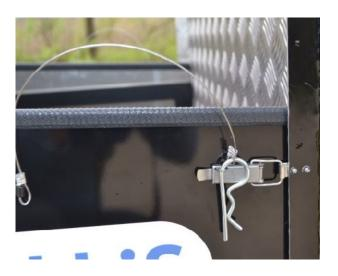
Vor dem Öffnen der Klappe die Sicherung durch kräftiges Hochziehen entfernen. Öffnen Sie dann die **Schnalle**.
