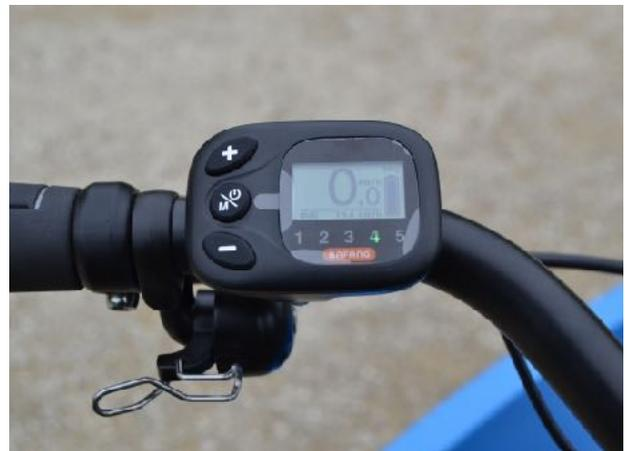
**4.** Um den E-Antrieb zu aktivieren, **drei Sekunden** auf den mittleren **An/Aus-Knopf** drücken. Die Antriebsstärke über **+** und **- Zeichen** ändern. Die max. Unterstützung beträgt 25 km/h.
