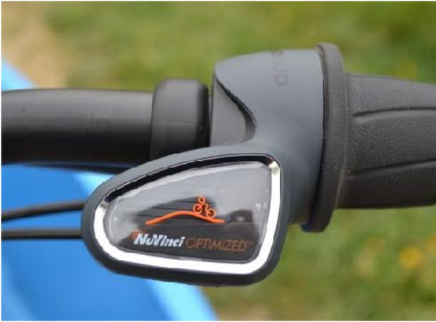
5. Verändern Sie die **Gangschwere** über die stufenlose Nabenschaltung.
